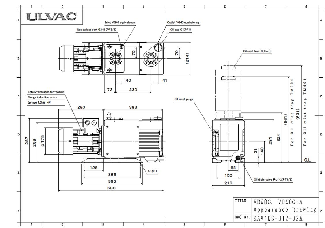
Fig. 5 Dimensional drawing VD40C, VD40C-F, VD40C-N
